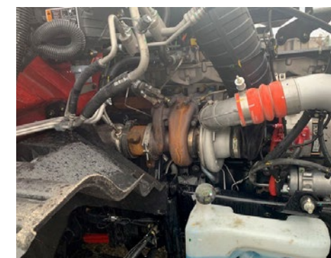
Côté droit du moteur à turbocompresseur du camion S13
